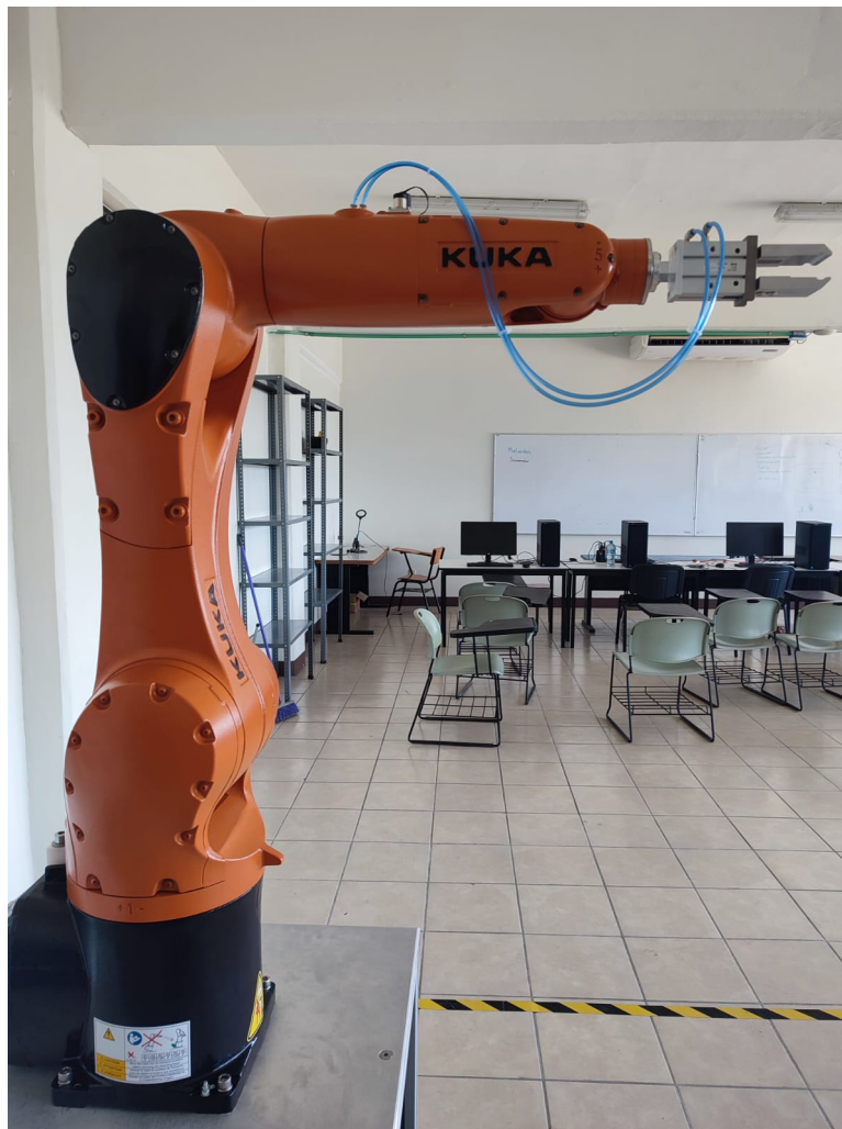
Figura 3.6: Brazo Manipulador KR6 R900 Sixx en posición Home
