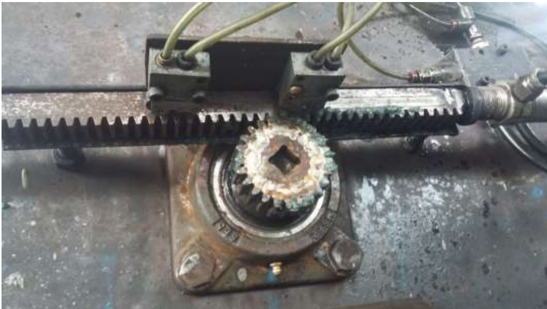
Ilustración 14 En esta imagen se muestran los 2 Micros (válvulas 3-2), cremallera, piñón, chumacera superior.
