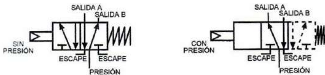
Ilustración 10 Acción de válvula 5/2
