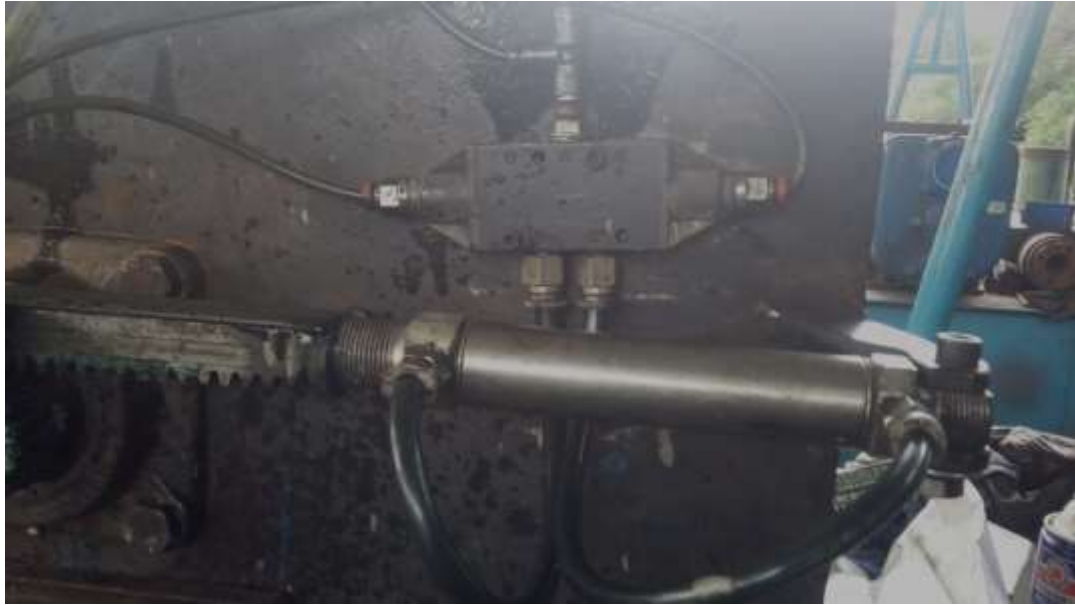
Ilustración 13 En esta imagen se muestra el cilindro neumático, válvula 5-2 pilotada
