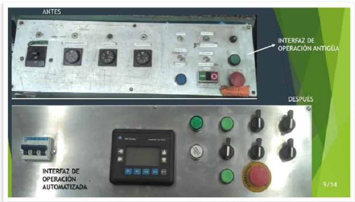
Optimización de interfaz operador-maquina, utilizando HMI Panelview 300 micro de la compañía Allen Bradley.
