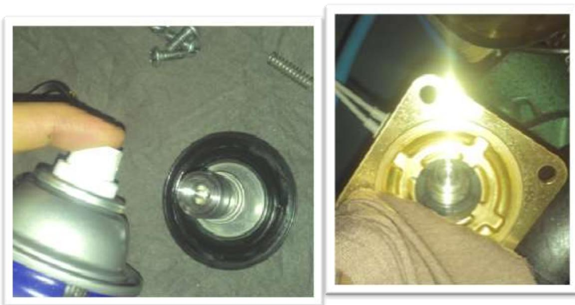
Figura. 47 Lubricación y retiro de suciedad de válvula de diafragma.
