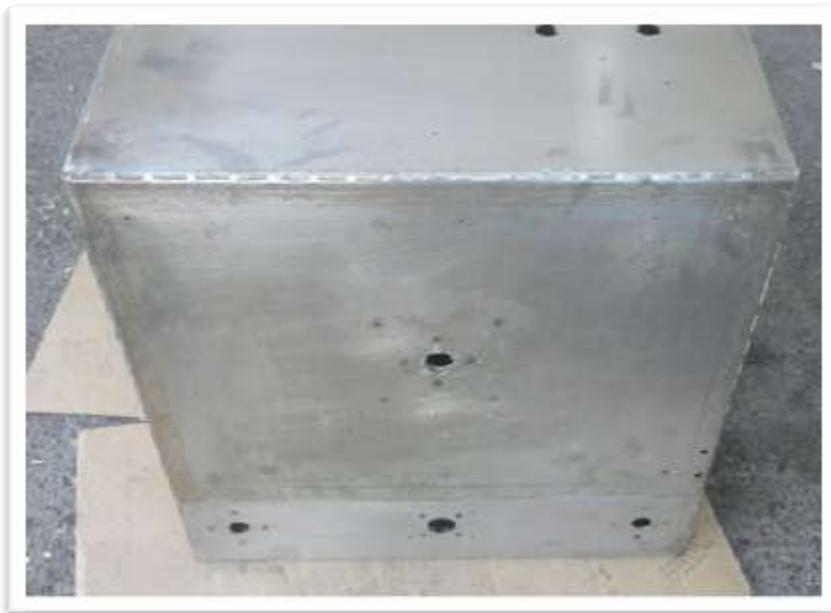
**Pulido de estructura de Termoformadora Chica II.**
