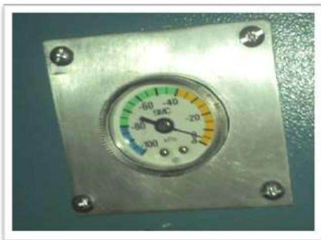
Figura. 19 Imagen de vacuómetro.
