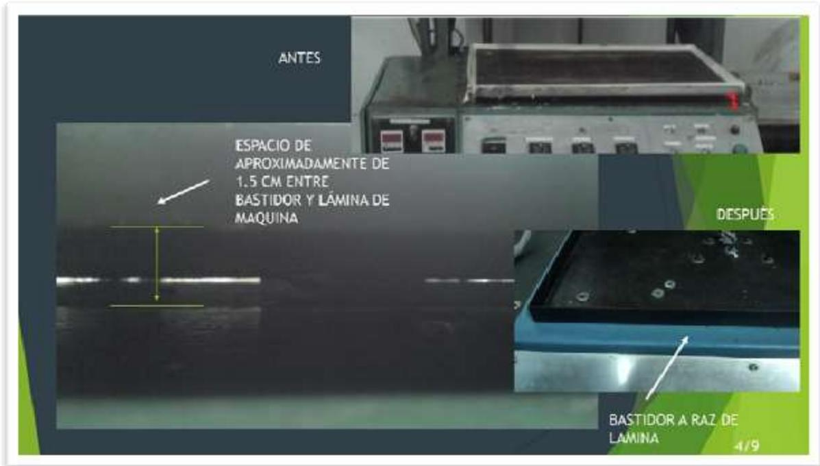
En relación a la fuga de vacío de la Termoformadora Chica II, se le atribuye el desnivel de 1.5 cm entre el bastidor y lamina de maquinaria. Se colocó a nivel de lámina la placa portamolde y se le colocaron empaques a cada tornillo de anclaje.
