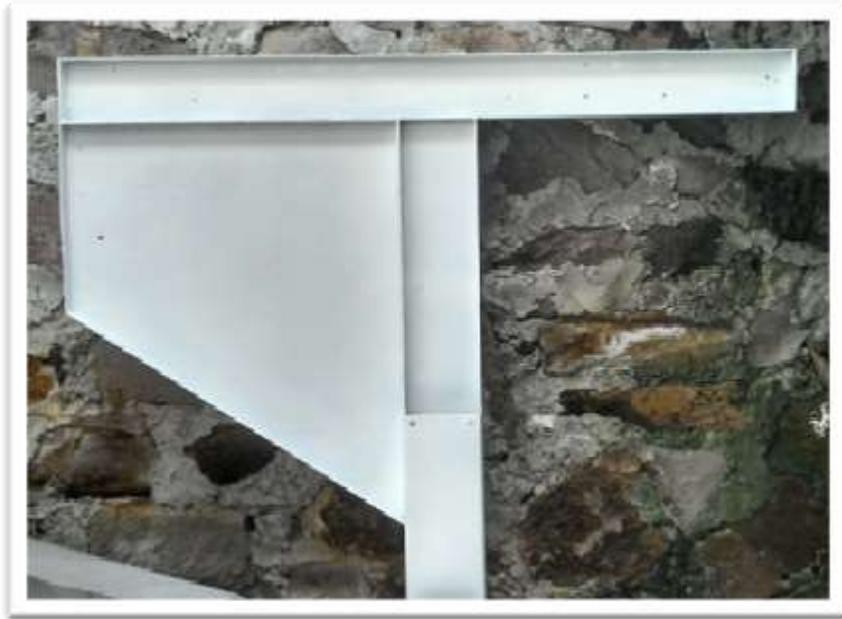
**Pintado de estructura mecánica sujetador derecho de rieles de horno en estilo martillado en Termoformadora Chica II.**
