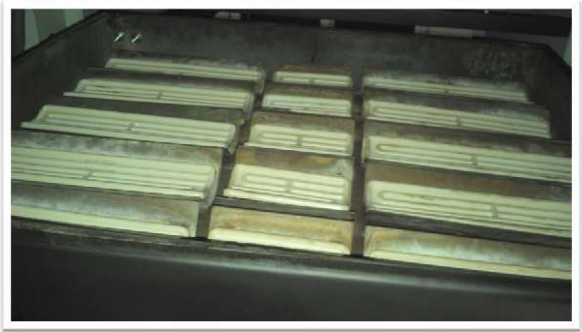
**Colocación de resistencias infrarrojas de 500 y 1000 watts en horno de Termoformadora Chica II.**
