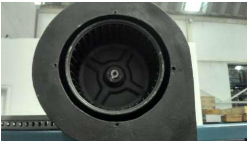
Figura. 3 Alabes de ventilador de Termoformadora.
