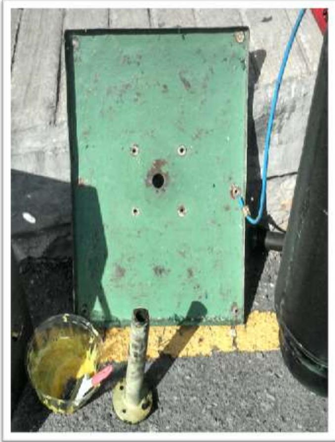
**Extracción de placa sujetadora de molde y conexión auxiliar de vacío.**
