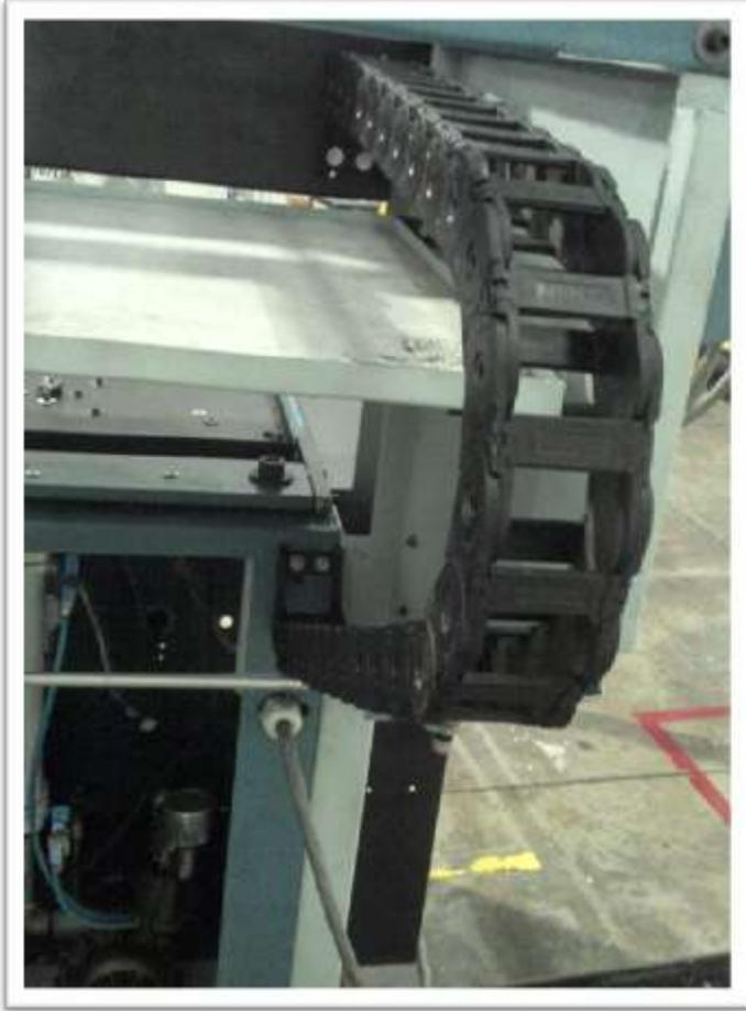
**Colocación de cadena portacables de horno en Termoformadora Chica II.**
