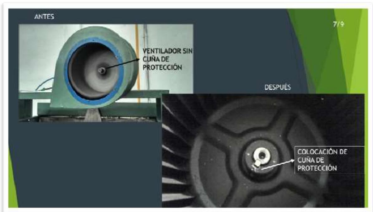
Se maquinó eje de giro de ventilador de Termoformadora Chica II, realizando un espacio para la colocación de una cuña de protección.
