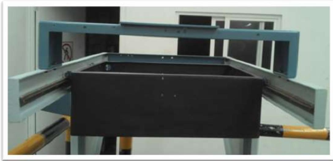
**Armado de las diferentes partes de la Termoformadora Chica II.**
