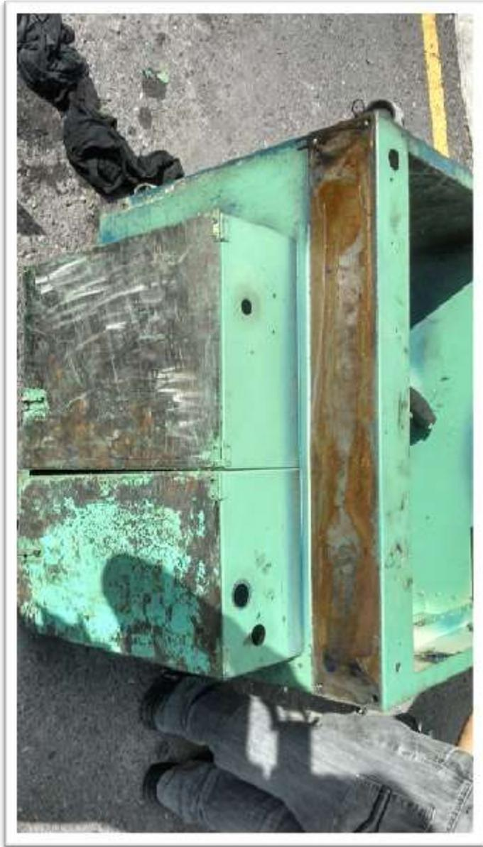
**Extracción de rieles porta-horno de Termoformadora Chica II.**
