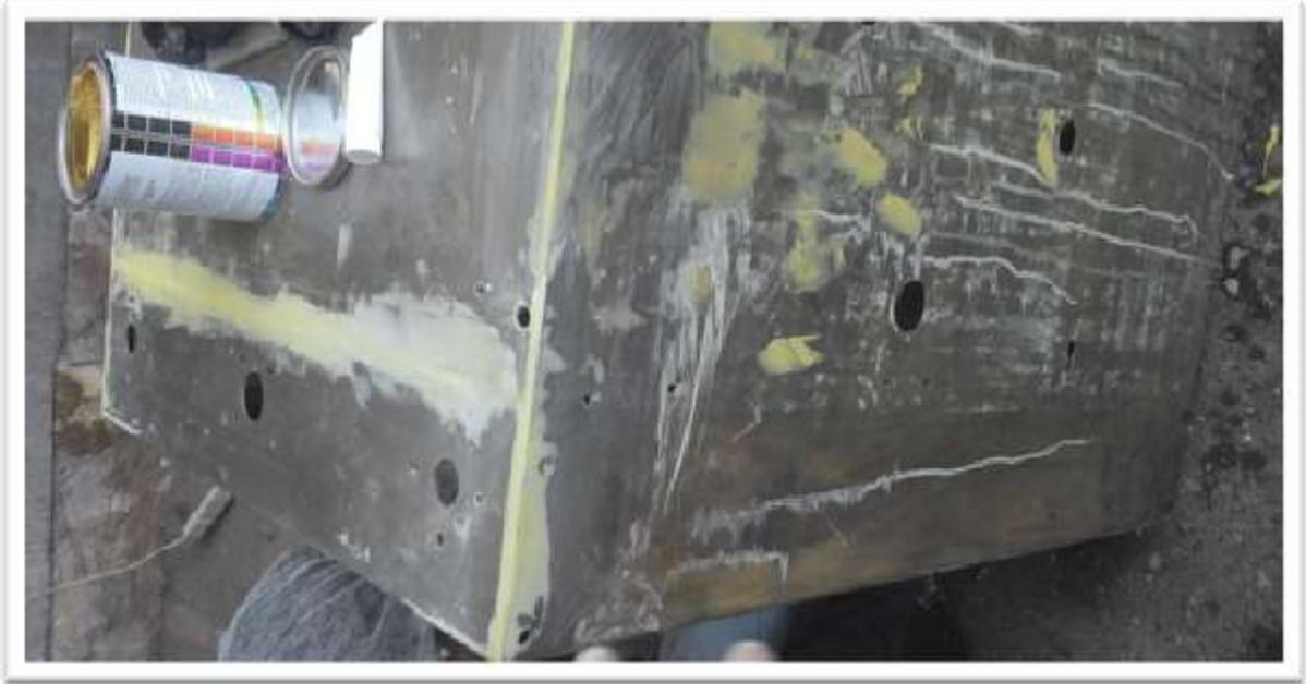
**Resane de Termoformadora Chica II.**
