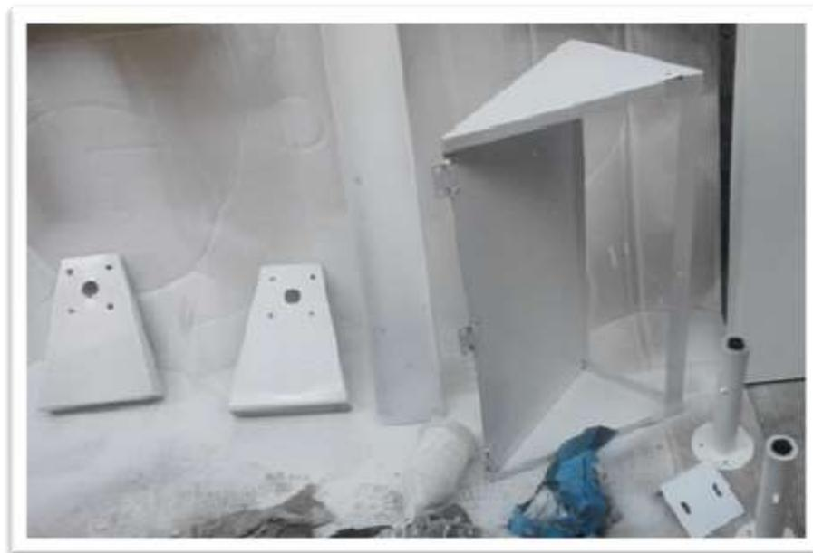
**Pintado al estilo martillado de componentes faltantes en Termoformadora Chica II.**
