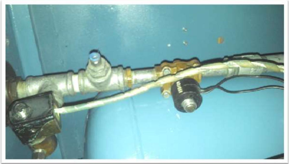
**Instalación de válvula de diafragma y empaques de vacío a bastidor.**
