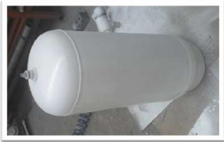
**Pintado al estilo martillado de componentes faltantes en Termoformadora Chica II.**
