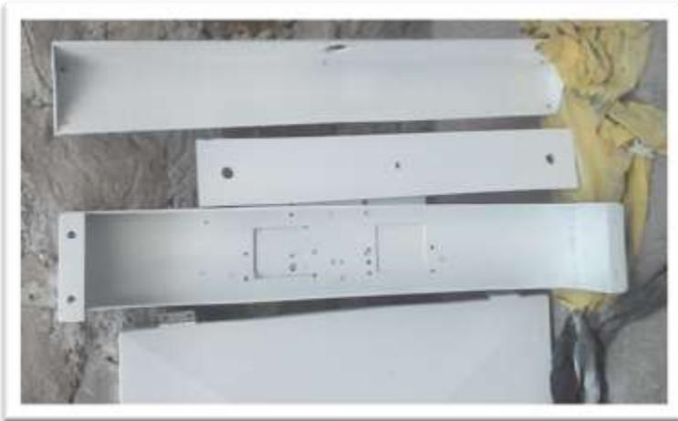
**Pintado al estilo martillado de componentes faltantes en Termoformadora Chica II.**
