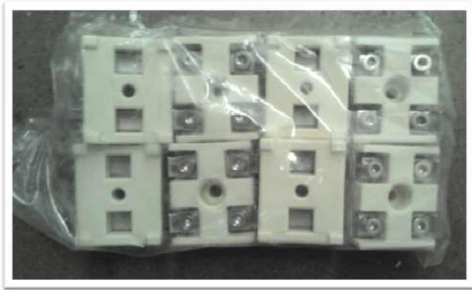
**Clemas de potencia para conexiones de resistencias a 1000 y 500 watts.**
