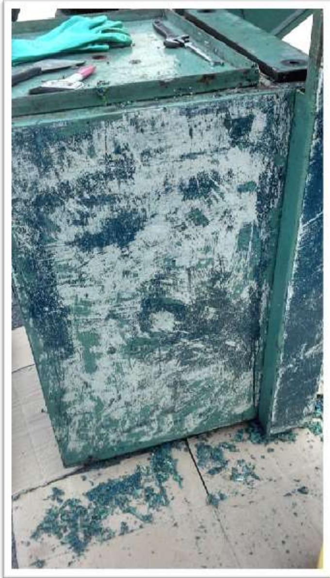
**Extracción de pintura en parte inferior de Termoformadora, para su posterior remodelación.**
